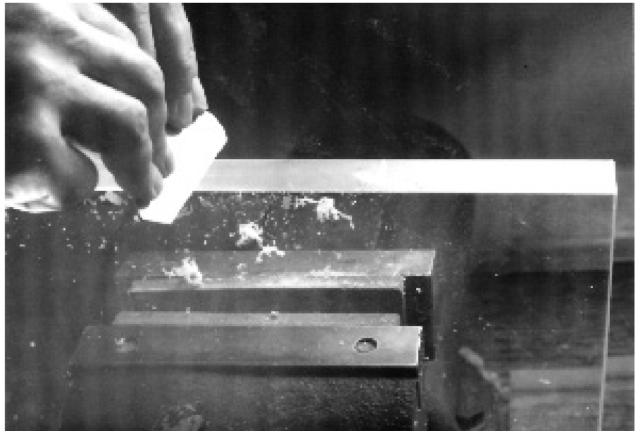
Abb. 35: Abziehen von PLEXIGLAS® mit Ziehklinge
