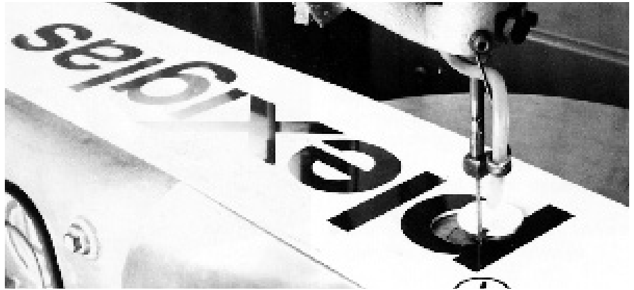
Abb. 9: Schwingsäge schneidet Schriftzug PLEXIGLAS®
