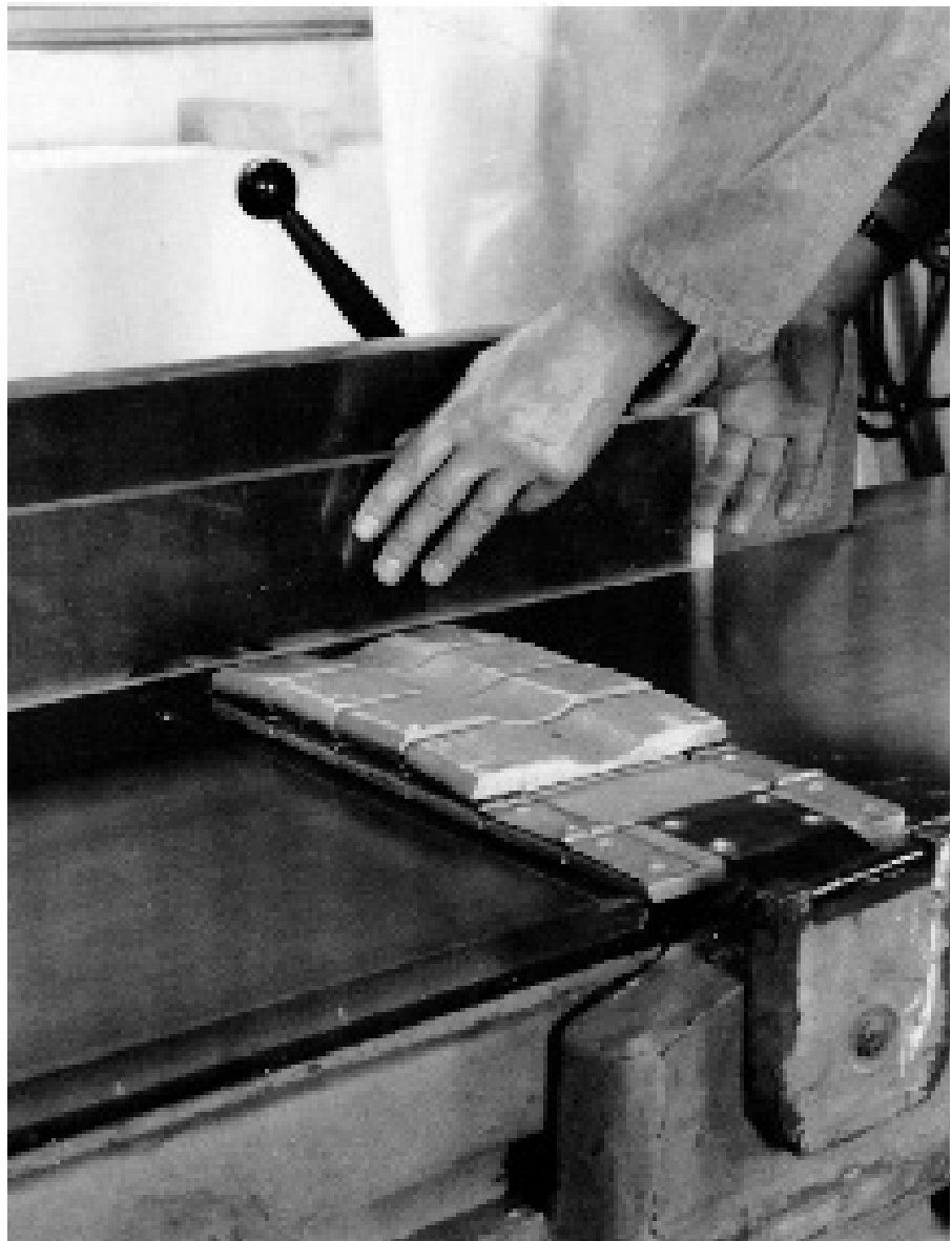
Abb. 36: Glätten der Kanten mit Abrichthobel
