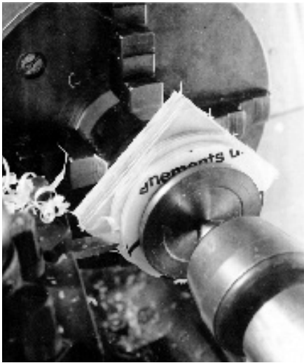
Abb. 30: Scheiben-Runddrehen zwischen Spannfutter und Reitstock
